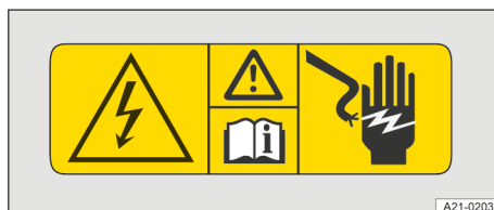
Bild 6 Varningsskylt i utrymmet under huven.
