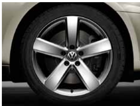
Lättmetallfälg "Daytona" 8 J x 18 med punkteringsskyddade däck 235/40 R 18
