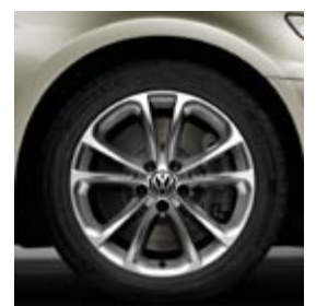
Lättmetallfölg "Spa" 8Jx17" med 235/45 R17-däck. Standard V6.
