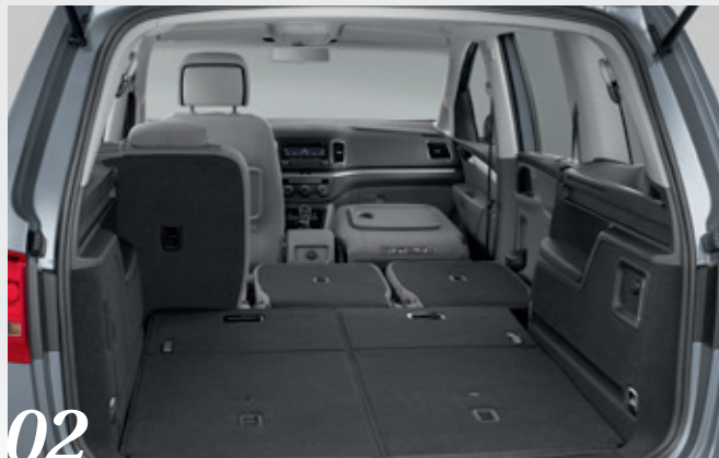
7-sitsutförande med Easy Fold-system samt fällbar passagerarstol
