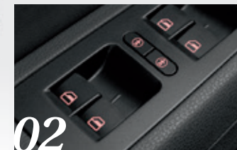
Elfönsterhissar, fram och bak
