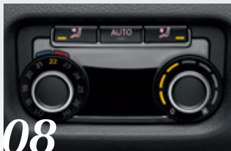
Manöverpanel bak för klimatanläggningen
