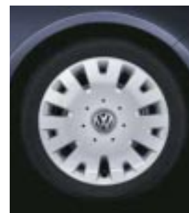
Stålfälg FSI 14" (däck 185/60 R14) med hjulsida i plast.
