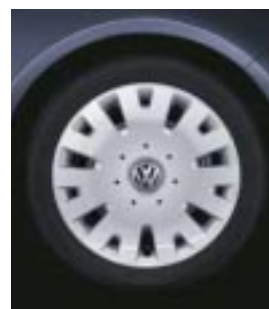
Stålfälg FSI 14" (däck 185/60 R14) med hjulsida i plast.
