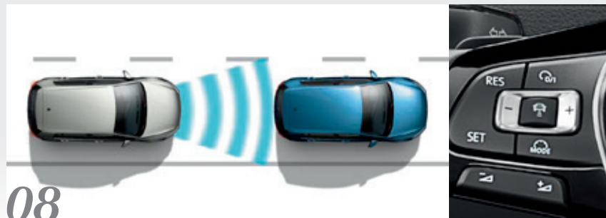
Adaptiv farthållare, ACC, inklusive Front Assist och City Emergency Brake
