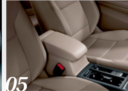
Mittarmstöd fram med luftutsläpp till baksätet
